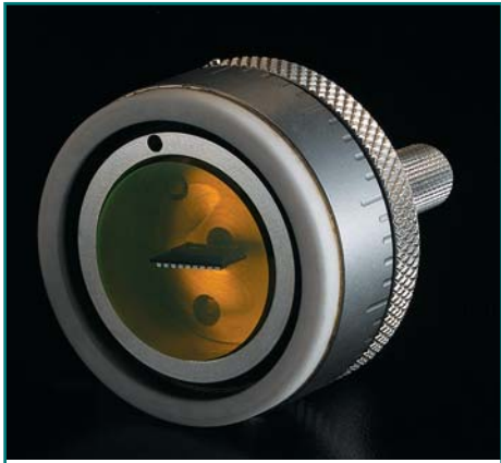
Рис. 4. Держатель образца для ручной подготовки. Accustop (Struers)
