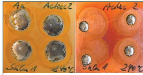
Рис. 1 Оплавленные шарики припоя SnCu1 на поверхности NiP/Au (слева) и на поверхности Cu/OSP (справа)
