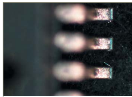
Рис. 8. Оловянный «ус» на контакте компонента QFP
