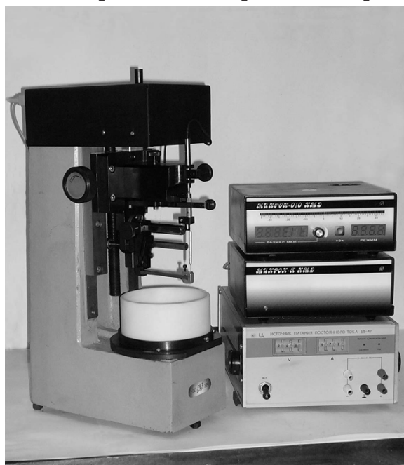
Рис. 1. Прибор АСБ-1 для автоматизированного определения остаточных напряжений
