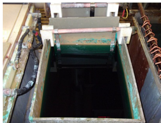
Рис. 2. Мембранный электролизер в ванне улавливания после ванны никелирования
